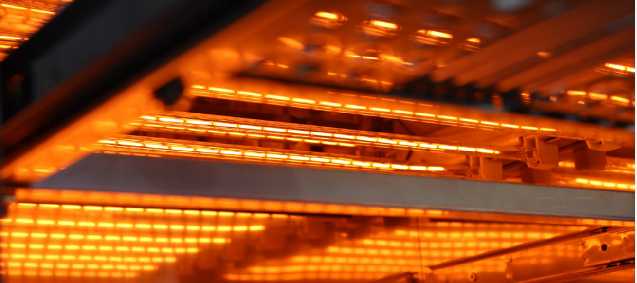
Bild 3: Infrarotstrahler im Einsatz (Quelle: InfraBioTech GmbH)
